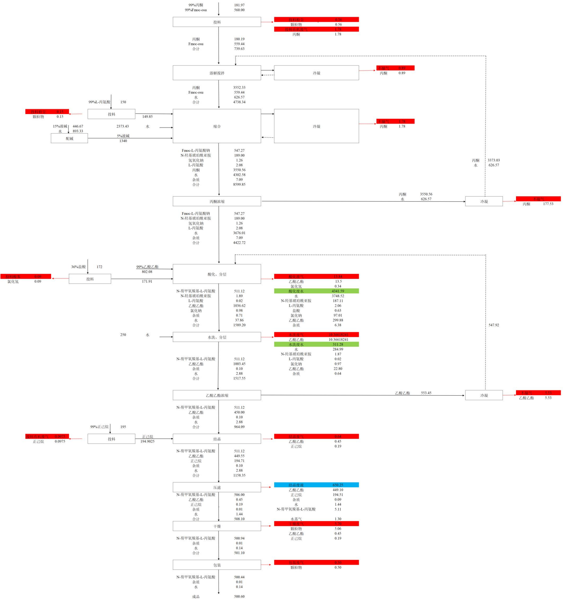
图 4.2.2-3 N-苄甲氧羰基-L-丙氨酸物料平衡图 (kg/批次)
